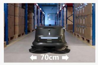
Ancho de limpieza efectivo de 70 cm; cubre fácilmente pasillos estrechos con un solo recorrido de ida y vuelta
