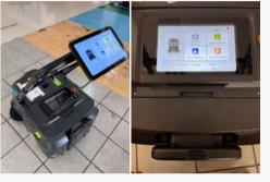
Pantalla táctil de 10 pulgadas, equipada con una cubierta protectora, extraíble para su uso y con cable retráctil de muelle.
