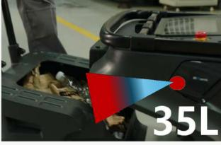
Contenedor de basura de gran capacidad de 35 litros, con detección inteligente de nivel de llenado. Al estar lleno, regresa automáticamente al punto de mantenimiento y emite una alerta para vaciarlo
