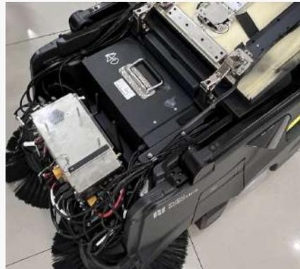
Capó de tipo hatchback para acceso rápido a mantenimiento
